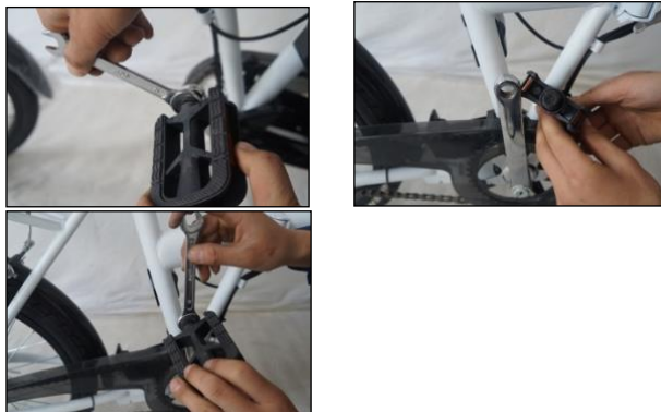
Figura 4 – Montaggio dei pedali.
