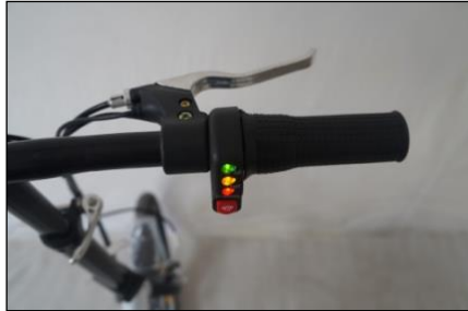
Figura 11 – Led visualizzazione carica batteria e accensione.
