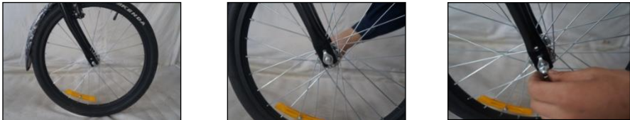
Figura 3 – Montaggio della ruota anteriore.
