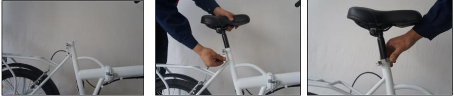
Figura 6 – Montaggio e regolazione della sella.
