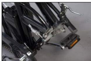
Figura 2 – Apertura e fissaggio del telaio.
