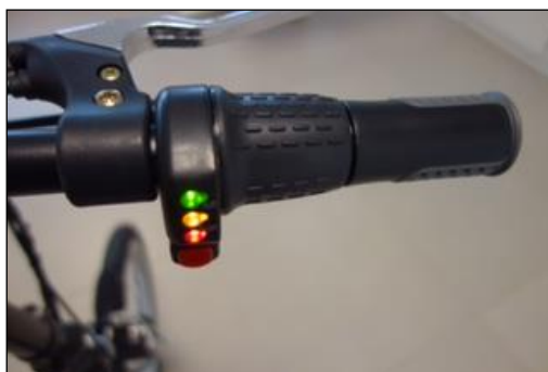
Figura 17 – Visualizzatore del livello di carica della batteria.
